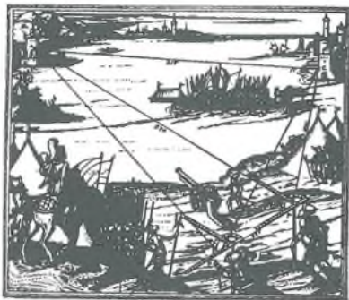
Vojenská měřiči zjišťují vzdálenost nepřátelské pevnosti na protějším břehu (podle rytiny z r. 1645)
