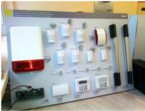
Rys.2 Przykład stanowiska pomiarów czujników systemu alarmowego
