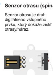
**Senzor otrasu (spínač)**
